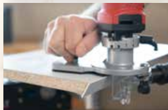
Duży stół roboczy zapewnia pewne prowadzenie maszyny nawet przy skośnych krawędziach.
