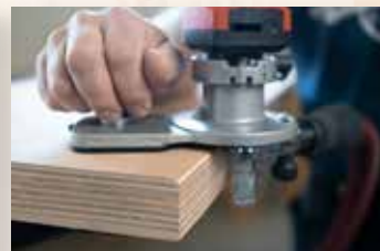
Nawet krawędzie z litego drewna można bez problemu obrabiać przy użyciu frezów dostępnych w sprzedaży.
