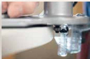
W przypadku delikatnych materiałów pierścieniowy hamulec cierny zapobiega powstawaniu brzydkich śladów przy obróbce.
