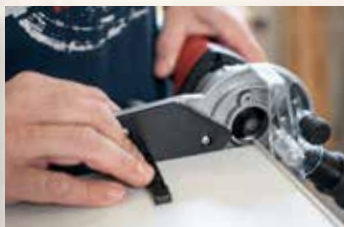
Podłączany ogranicznik służy jako niezawodne prowadzenie podczas obróbki narożników.
