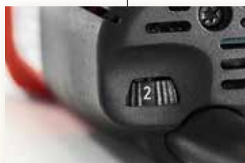
Płynna regulacja prędkości frezowania dla optymalnych osiągnięć
